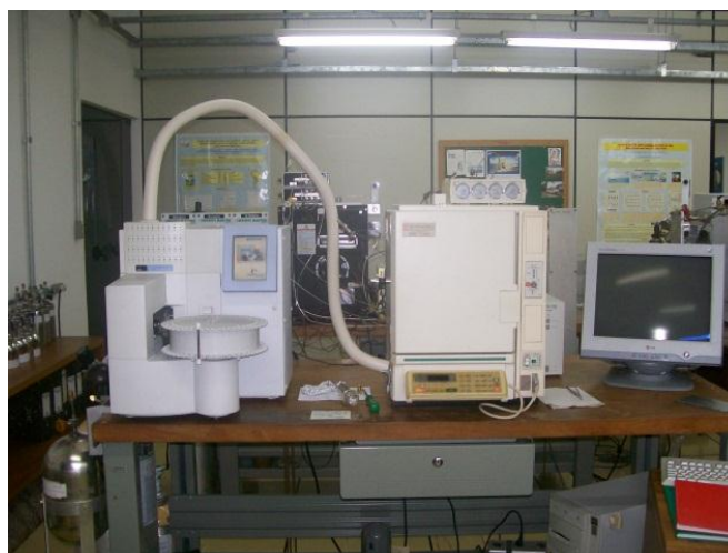
Figura 4.5 Esquema dos equipamentos utilizados para análise, estando o dessorvedor à direita, cromatógrafo e computador para representação gráfica
